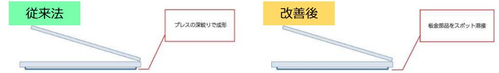
医療装置や検査装置などの産業用機器・装置のカバー扉を取り付ける際に、装置カバー扉がしっかりと決まった位置で止まるように段差を付ける必要があります。量産品の医療機器や検査装置の場合であれば、プレス加工の深絞りにてこの扉の段差の成形を行います。装置カバー扉の取り付け部分の段差成形方法を、プレス加工での深絞りから精密板金部品のスポット溶接に変更することで、加工コストダウンを行うことができます。
